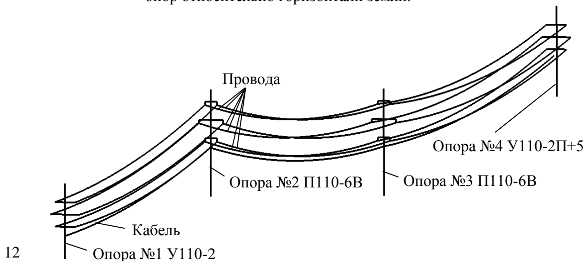
Рис. 6. Профиль анкерного участка с величинами смещений опор относительно горизонтали земли.
